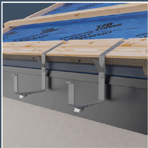
Anbau der Rinnenhalter in die vorher erstellten Aussparungen der Traufbohle.
