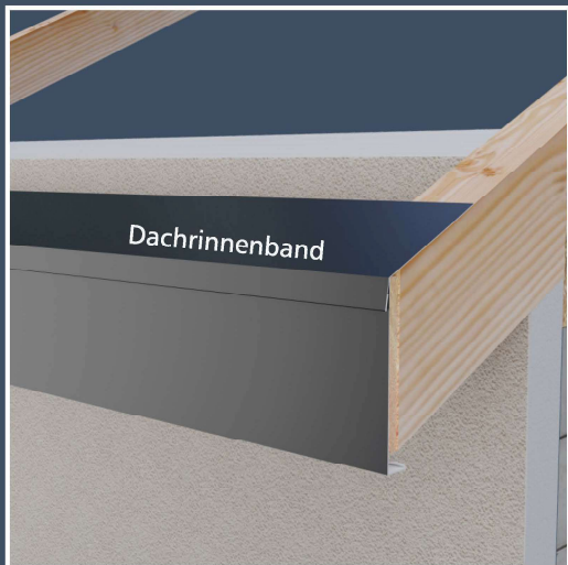
Aufbringen des Dachrinnenbandes an die Kante der Traufbohle (Kondensation).
