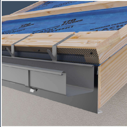
Fertig eingehängte Kastenrinne.
