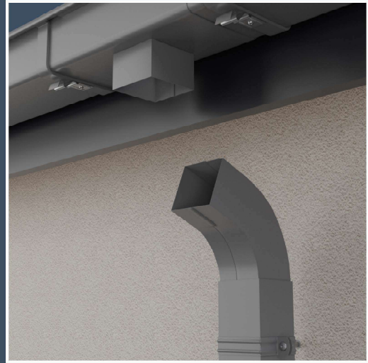
Fügen Sie den quadratischen Rohrbogen ohne Verwendung einer Muffe in das Fallrohr ein. Achten Sie darauf, dass der obere Rohrbogen mindestens 65 mm tief in das Fallrohr eingeführt werden muss.
