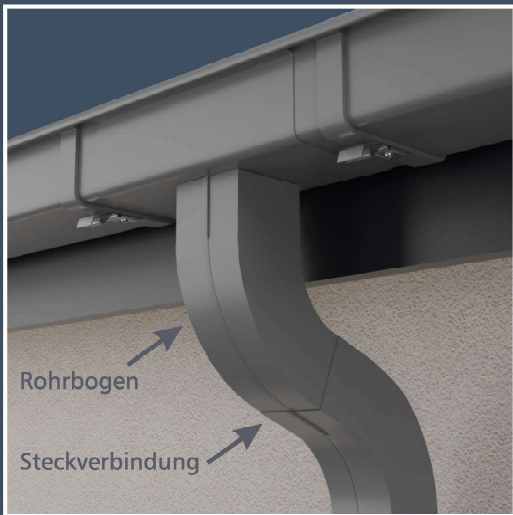
Die Montage des Winkelstücks an den Auslauf des Ablaufstutzens erfolgt durch ineinanderstecken und bedarf keiner Schrauben oder Kleber.
