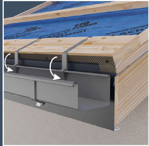
Umbiegen der Blechelemente am Rinnenhalter um die Kastenrinne.
