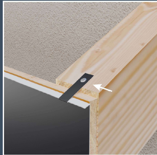
Das eingehängte untere Traufblech wird oben mit einer Winkelhalterung an den Dachsparren fixiert.
